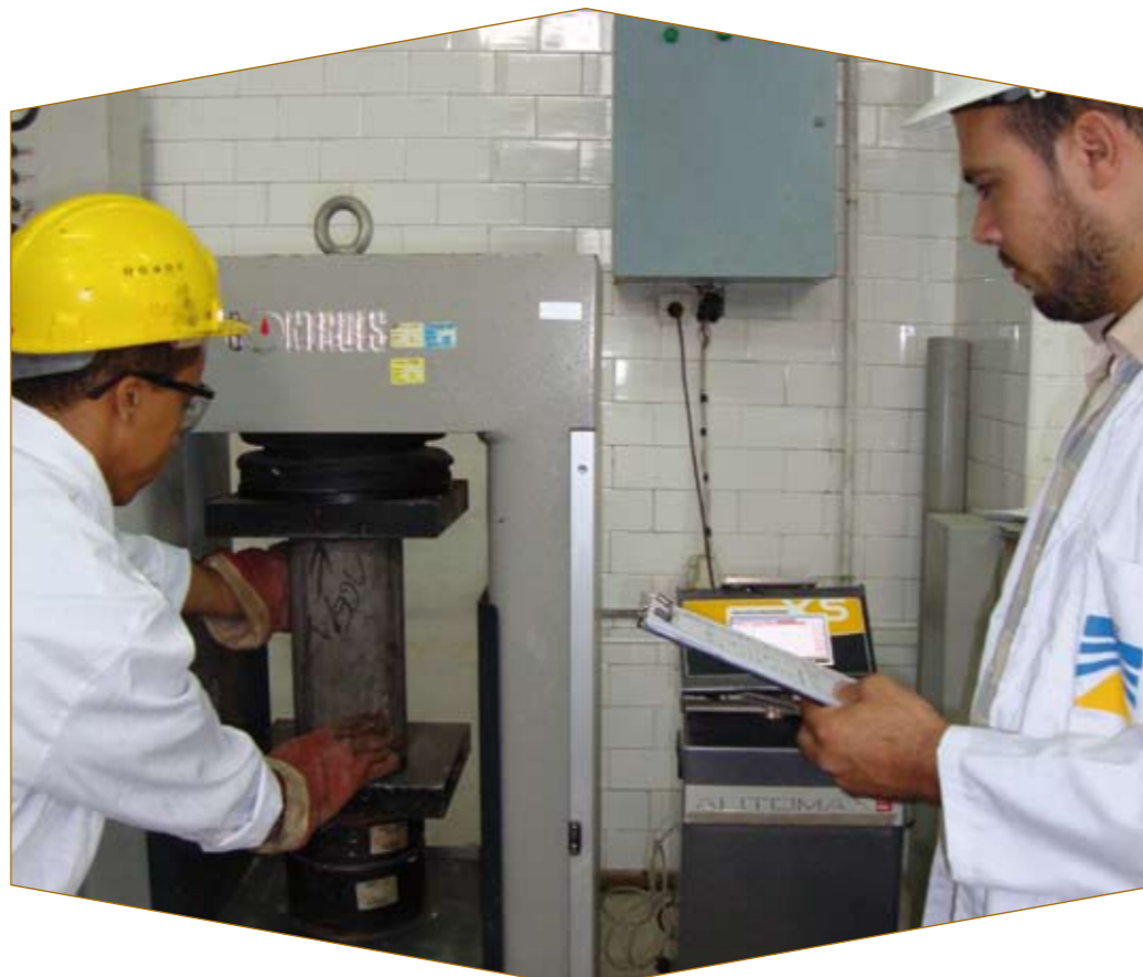
La recherche appliquée demande de lourds investissements en équipements. Ici des agents du CTR de Casablanca en train de réaliser un essai de compression selon la norme NF EN 12390-3
