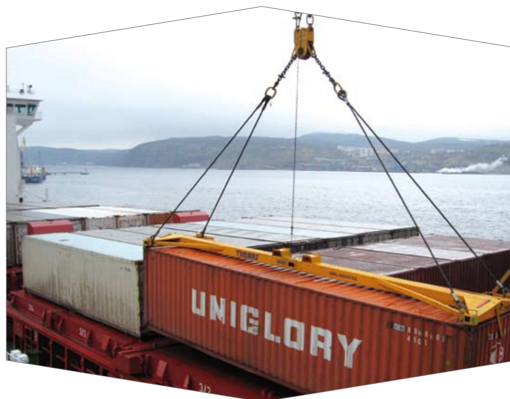
Les câbles en acier de levage sont régulièrement contrôlés en raison des importants mouvements auxquels ils sont soumis.
